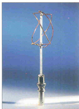
Bild 22. Das aufgebaute Muster der Quadrifilar-Backfire-Helix-Antenne.
