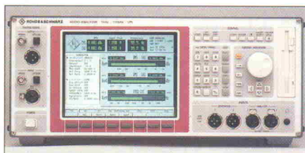
Rohde & Schwarz' UPL kann pro Kanal 17 Kurven nacheinander messen, darstellen und speichern.
